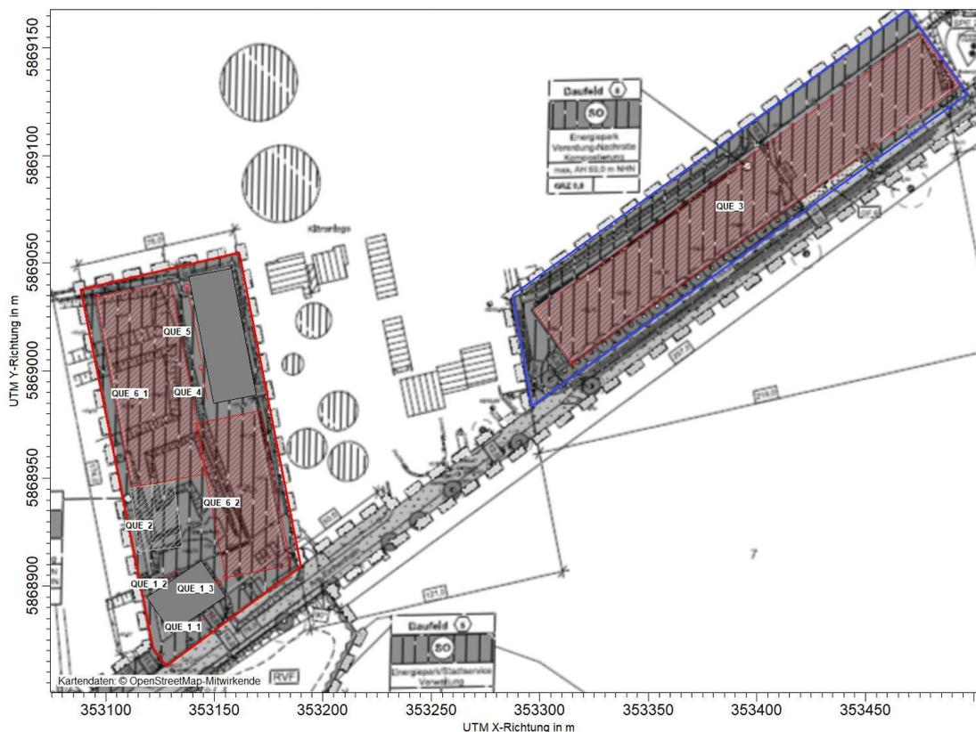
Abbildung 4. Lage der Emissionsquellen (Flächenquellen – rot schraffiert bzw. dünne rote Linien) der Bioabfallbehandlungsanlage auf dem Baufeld Nr. 7 des B-Plans Nr. 66 (rot umrandet) sowie der Nachrotte auf Baufeld Nr. 8 (blau umrandet); Kartenhintergrund: [17].
