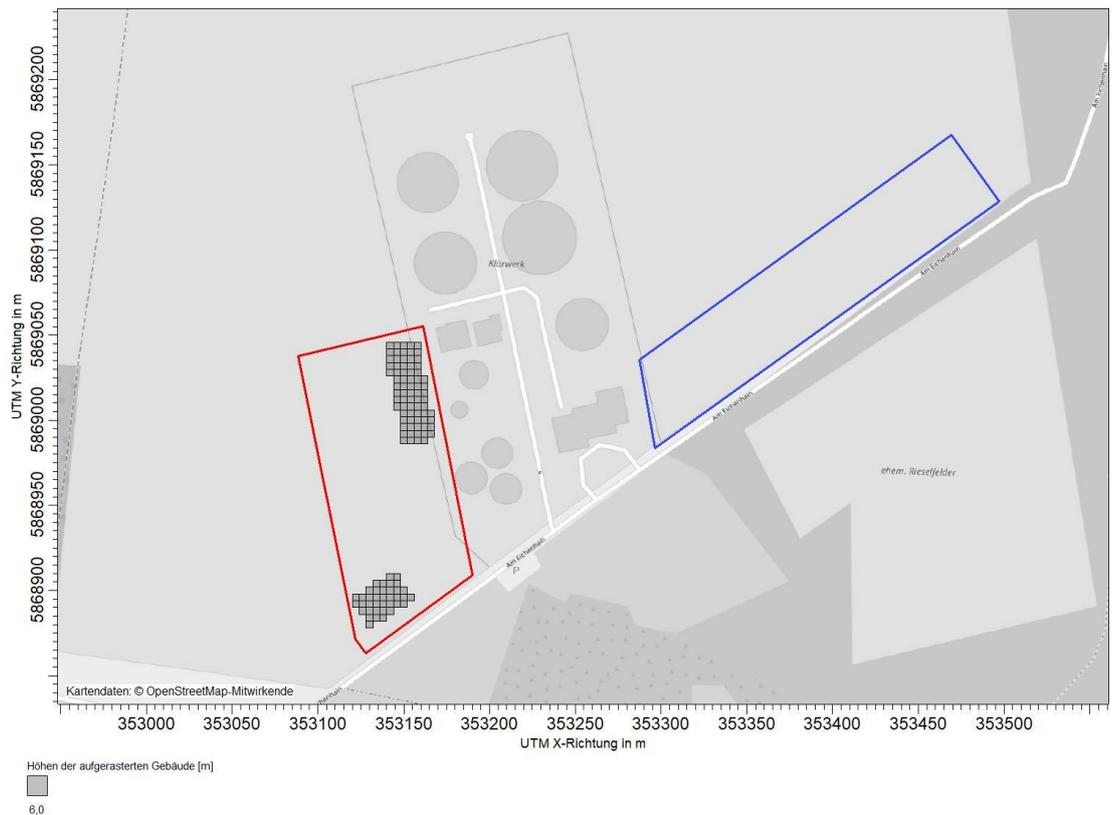
Abbildung 10. Gebäuderasterung in der Ausbreitungsrechnung; Bioabfallbehandlungsanlage auf dem Baufeld Nr. 7 des B-Plans Nr. 66 (rot umrandet) sowie der Nachrotte auf Baufeld Nr. 8 (blau umrandet); Kartenhintergrund: [17].
