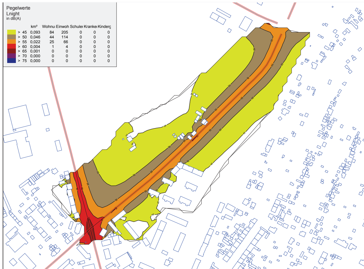
Abbildung 7-9 Isophonenbänder L_{\text{Night}} entlang der B 167 (Gerhart-Hauptmann-Straße) zwischen Wittstocker Allee und Babimost-Ring, Tempo 30 nachts
